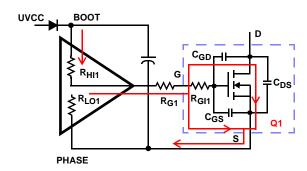
FIGURE 3. TYPICAL UPPER-GATE DRIVE TURN-ON PATH
