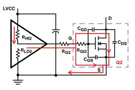
FIGURE 4. TYPICAL LOWER-GATE DRIVE TURN-ON PATH
